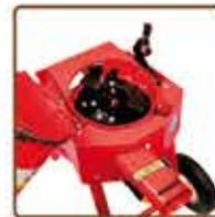
Sa capacité de broyage jusqu'à 40 mm de diamètre permet de traiter des volumes importants de déchets de taille tout en fabriquant un compost de qualité. Idéal taille de vert : lauriers, thuyas...
