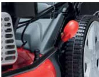
**Réglage centralisé de la hauteur de coupe**
