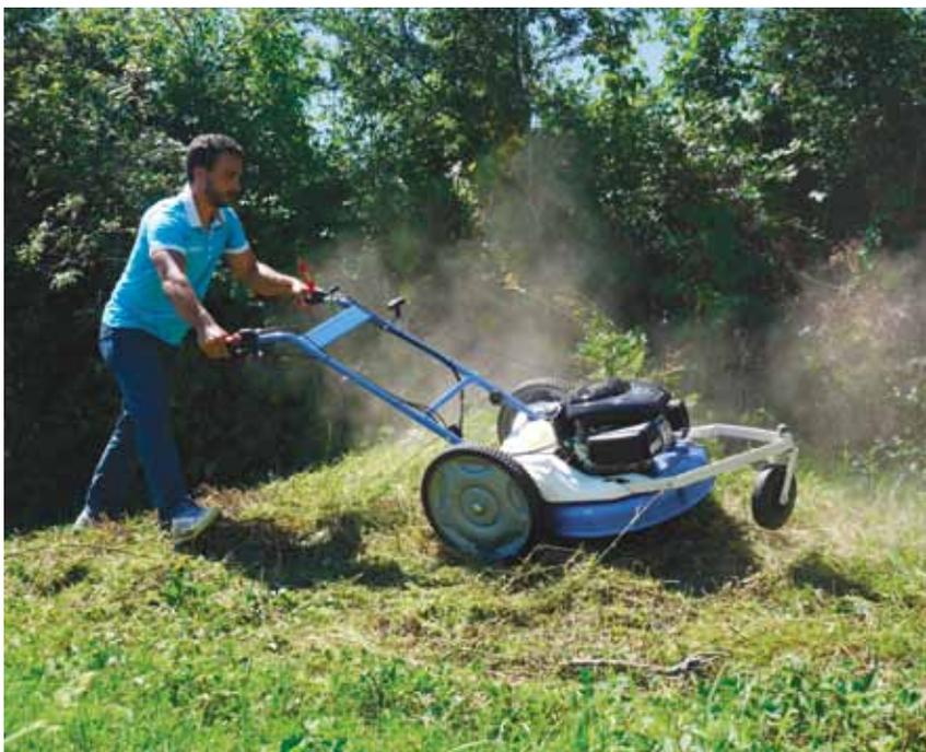
La débroussailleuse DB501KH est à la fois maniable et performante grâce à son réglage de hauteur de coupe centralisé au guidon et à ses grandes roues arrière.
